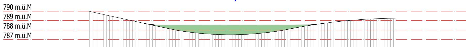
Das Aushubmaterial von der neuen Jauchegrube, das nicht wieder für das Hinterfüllen gebraucht wird, wird im Bereich Chillberg, (ca. 420m von der Jauchegrube entfernt) für das Ausgleichen der Bodenunebenheiten genutzt. Die Bewirtschaftung des Bodens mit den Maschinen ist im Moment durch die Bodenunebenheiten erschwert. Durch das Auffüllen kann für die Bewirtschaftung eine erhebliche Verbesserung erzielt werden.
